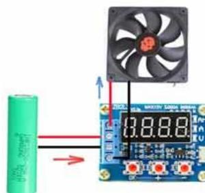
Gambar 2. Rangkaian *discharge* baterai
