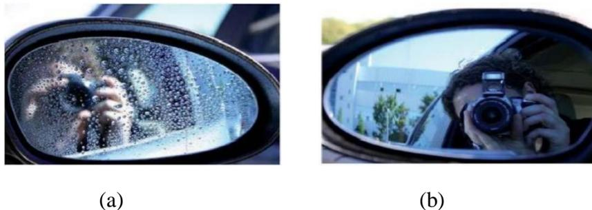
Gambar 5. Aplikasi Self Cleaning (a) Kaca mobil yang tidak dilapisi lapisan hidropobik (b) kaca mobil yang telah dilapisi lapisan hidropobik
