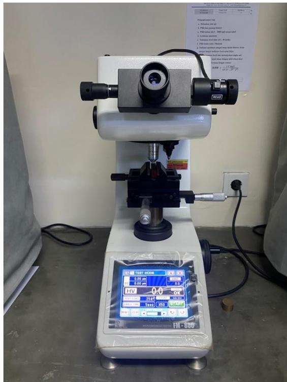
Gambar 3. Mesin Uji Kekerasan *Vickers*
