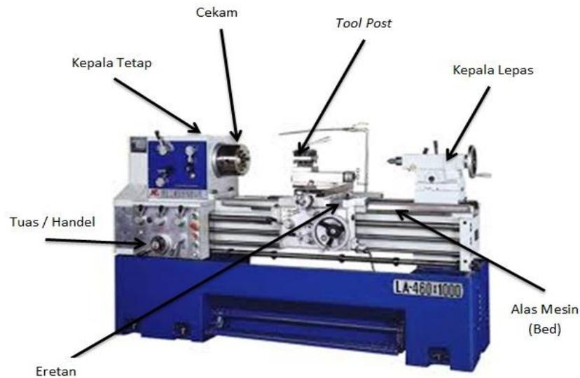
Gambar 3. Bagian-bagian utama mesin bubut
