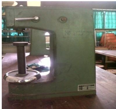
**Gambar 3. Alat Uji Kekerasan**
