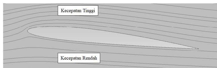
Gambar 12. Perbedaan Tekanan pada Sayap Pesawat
