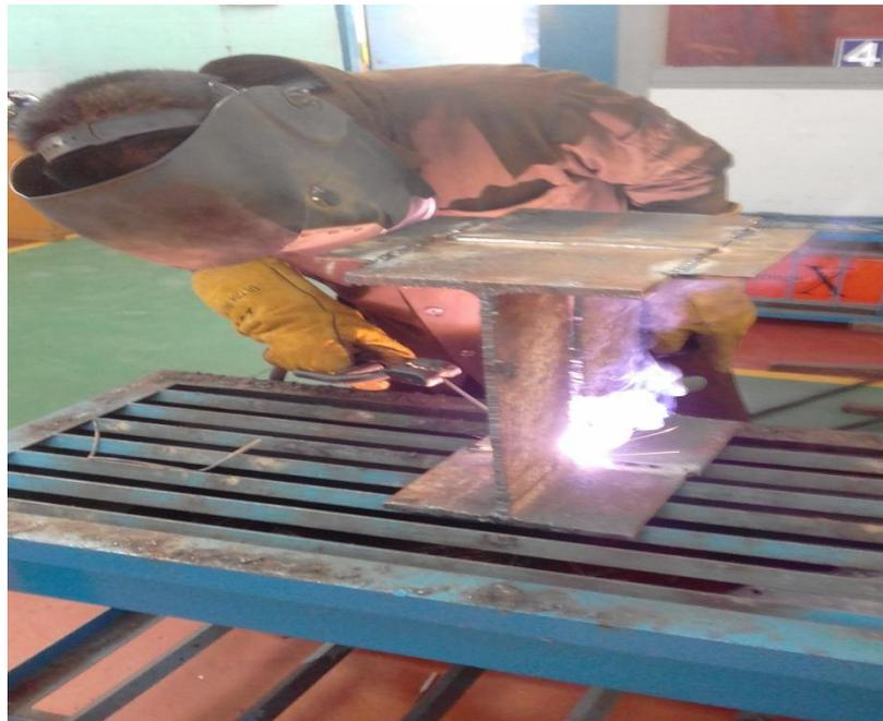
Gambar 4. Pengelasan penyambungan besi IWF 400
