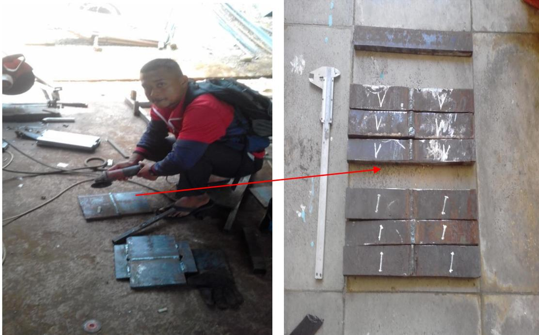
Gambar 7. Pembentukan Spesimen Yang Akan Diuji
