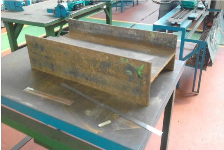
Gambar 1. Persiapan Bahan Untuk Spesimen Besi IWF 400
