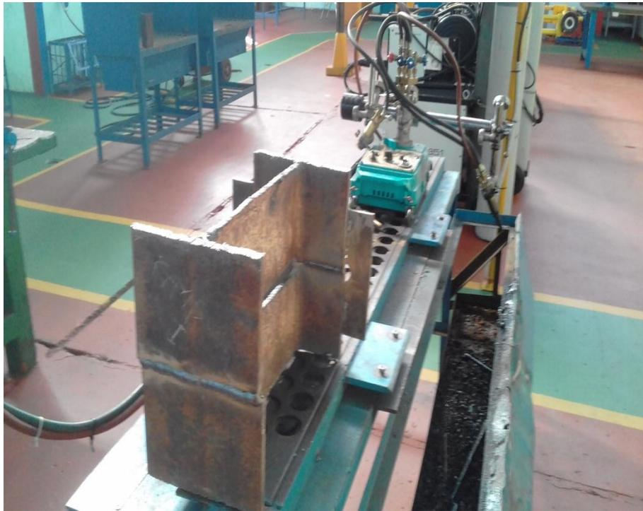
Gambar 5. Bahan Setelah Dilakukan Pengelasan
