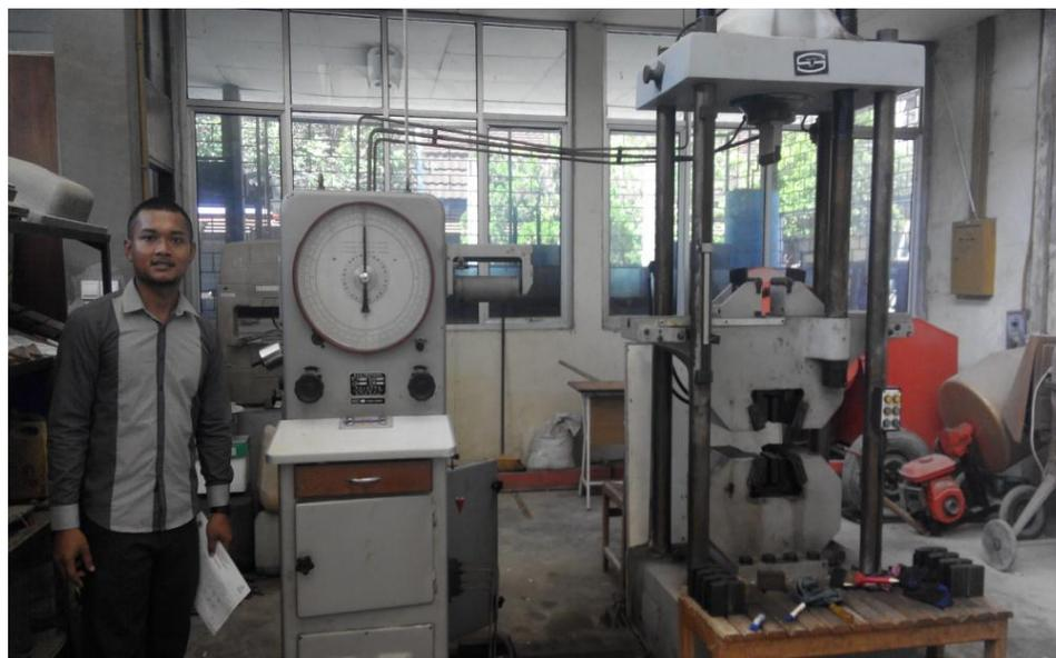
Gambar 8. Mesin Uji Tarik Universal dengan Model WE-1000 merk *Hydraulic Universal Material Testing Machine*
