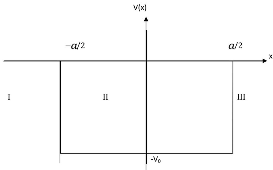
Gambar 1. Sumur Potensial yang Bersesuaian dengan Sebuah Kotak yang Dindingnya Keras Berhingga. (Erkoc,2006)
