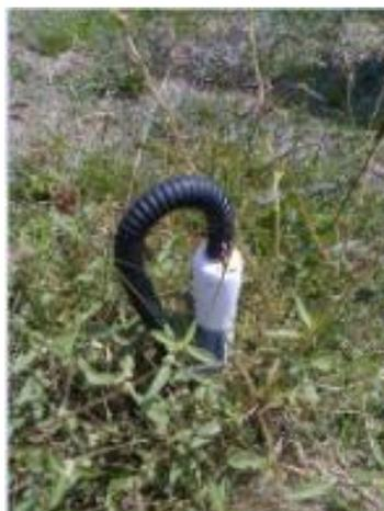
Gambar 1. Alat Ukur Suhu dan Kelembaban Tanah pada AAWS
