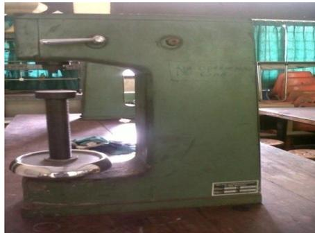
Gambar 5. Alat Uji Kekerasan
