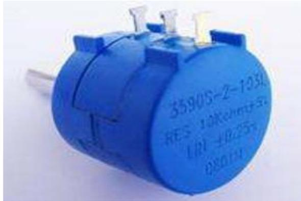
Gambar 8. Potensiometer *Multiturn*.
