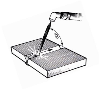
Gambar 1. Posisi bawah tangan (www.pengelasan.net)
