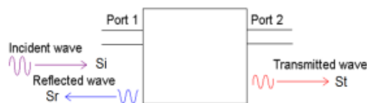
Gambar 2. Prinsip kerja VNA (Wandira, 2018)
