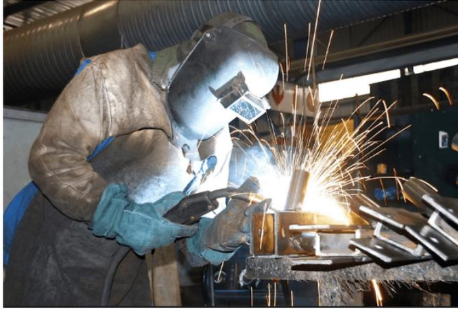
Gambar 2.17 Proses Pengelasan.
