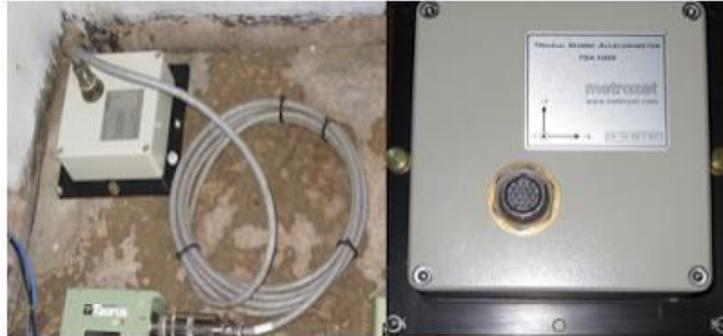
Gambar 7. Akselerograf tipe TSA 100S Metrozet
