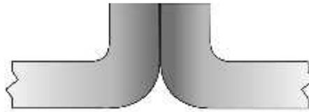
**Gambar 14.** Jenis Sambungan Tekuk atau Sisi
