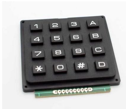
Gambar 29. Bentuk Fisik Keypad.
