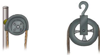
Gambar 2.4 katrol tetap pada tiang bendera dan katrol pada sumur timba
