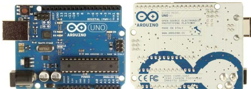
Gambar 3. Bentuk fisik Board Arduino
