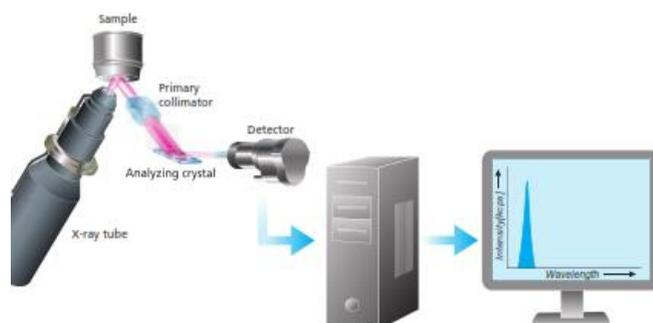
Gambar 8. Skema Kerja alat XRF
