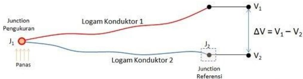
Gambar 2. Konstruksi Termokopel.
