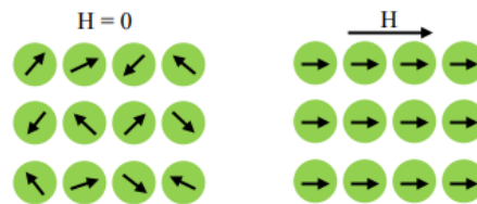
Gambar 12. Arah domain magnetik pada bahan bersifat Paramagnetik sebelum dan setelah diberi medan magnet luar ( H ). (David Halliday & Robert Resnick. 1978).
