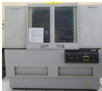
Gambar 20. XRD tipe X'PERT POWDER PW 30/40 (dokumentasi penulis)
