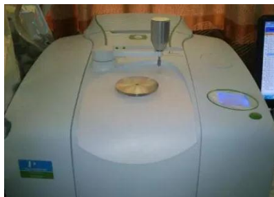
Gambar 24. Alat Uji FTIR di Kimia FMIPA UNP (dokumentasi penulis)
