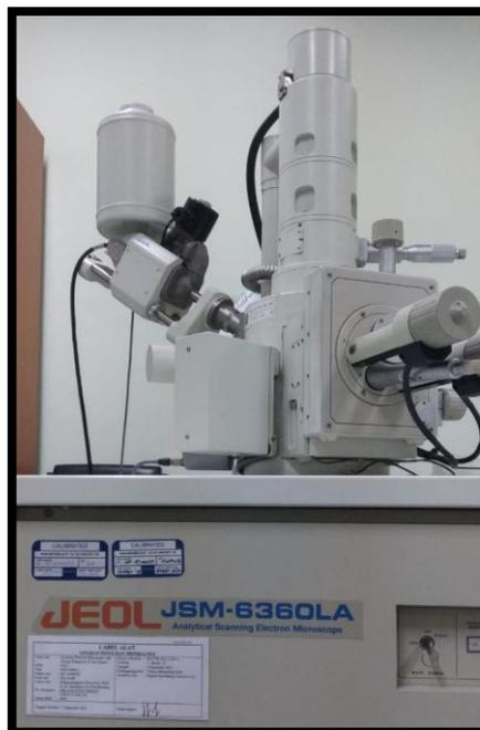
Gambar 14. Alat SEM (Doc: Laboratorium PPPG Bandung)
