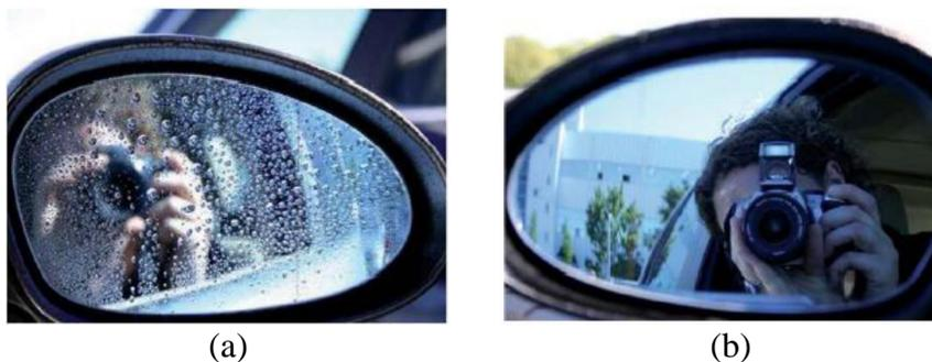
Gambar 5. Aplikasi *self cleaning* (a) Kaca mobil yang tidak dilapisi lapisan *hydrophobic* (b) Kaca mobil yang telah dilapisi lapisan *hydrophobic* (Putri, Ratnawulan, & Ramli, 2018)
