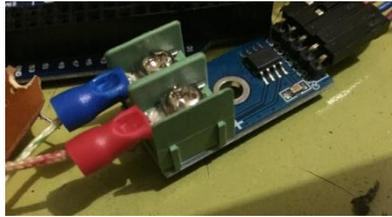
Gambar 9. Sensor *Thermocouple*
