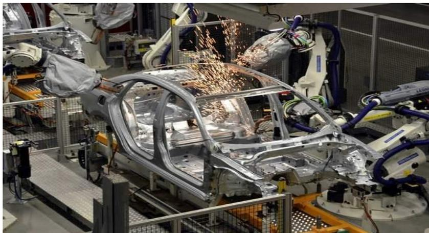
**Gambar 1: Pengelasan Titik Pada Kerangka Frame Kendaraan**
