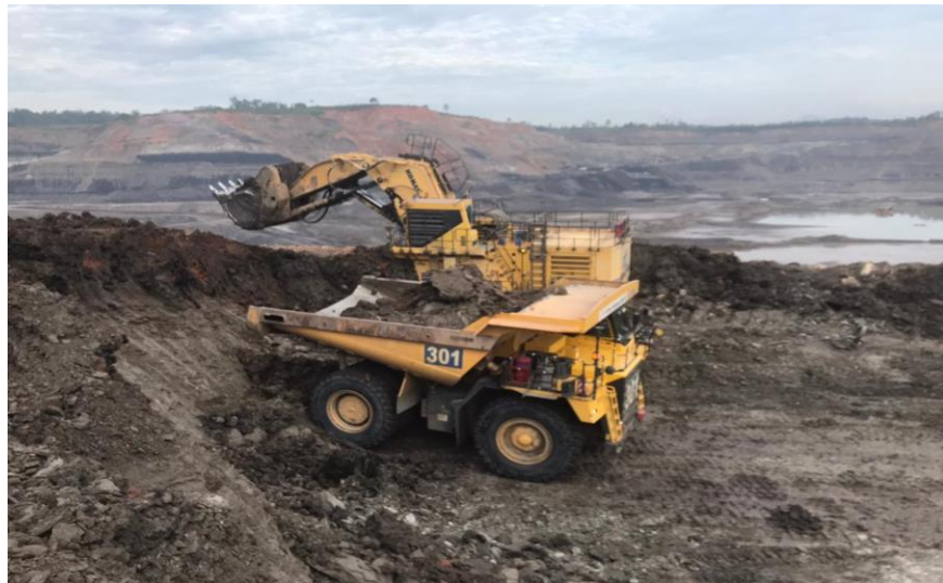
Gambar 7. Pola Muat Bottom Loading
