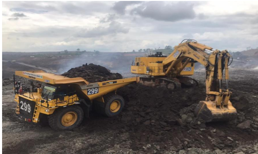
Gambar 6. Pola Muat Top Loading
