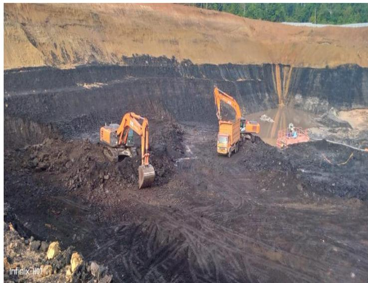
**Gambar 15.** Kondisi Jalan Yang Tidak Rata (*Undulating*)
