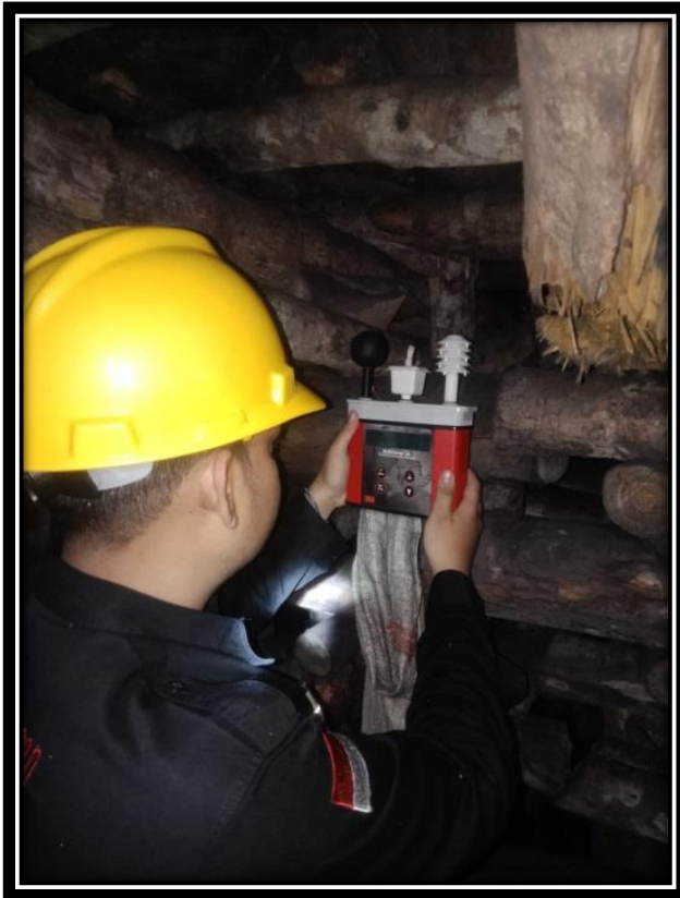
Gambar 3. Pengukuran Temperatur dan Kelembapan Udara
