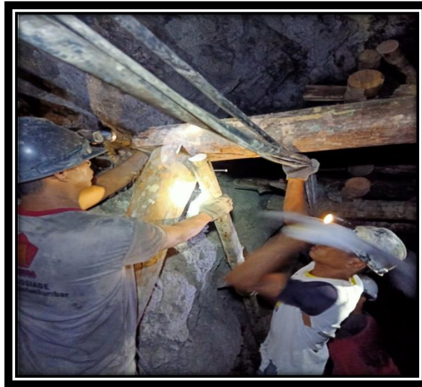
Gambar 8. contoh pemasangan kepala ram ( cap )
