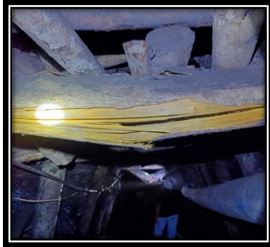
Gambar 19. cap yang patah di kedalaman 200 m
