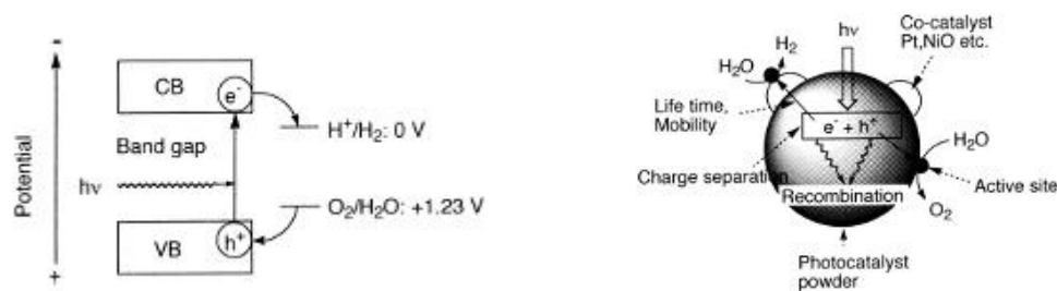
Gambar 1. Skema eksitasi VB ke CB (12) dan tahapan pemisahan muatan dan sisi aktif fotokatalis (12)
