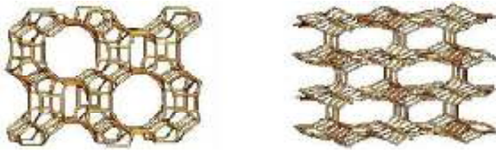
Gambar 2.4. Struktur mordenit (a) dan klinoptilolit (b) sebagai komponen utama zeolit alam Indonesia [Utubira, dkk, 2006].
