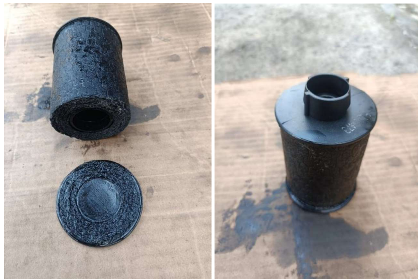
Gambar 3. Kondisi Filter Pecah Sebelum Jarak Tempuh 15.000 Km Sumber: (Dokumentasi Pribadi)
