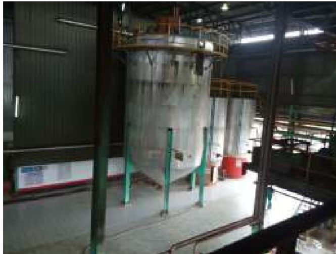
Gambar 3.9 Station Clarification (Stasiun Pemurnian)
