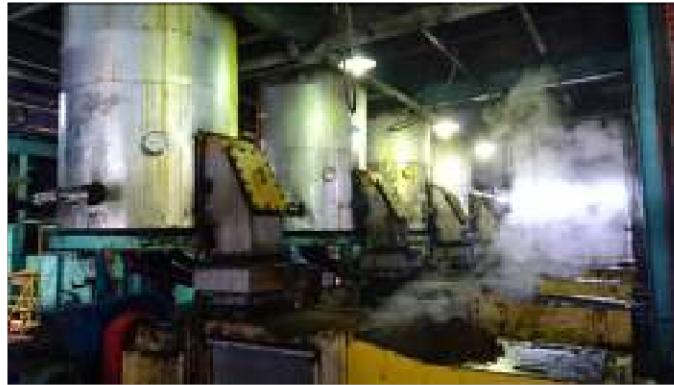
Gambar 3.8 Stasiun Kempa ( Pressing Station )
