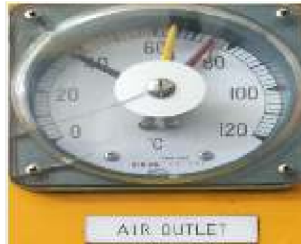
Gambar 4.11 Parameter Sisi Keluar (outlet) Air Cooler
