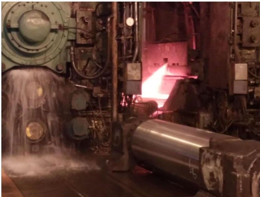
Gambar 3.6 Slab memasuki Finishing Mill
