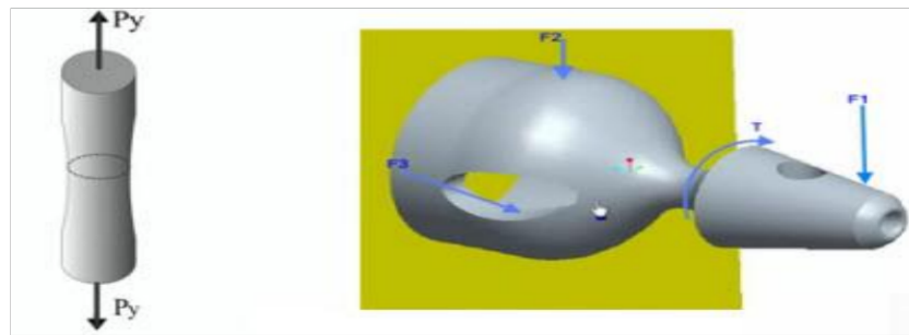
Gambar: 4.21 Sebuah tes ketegangan sederhana dan kondisi pembebanan kehidupan nyata
