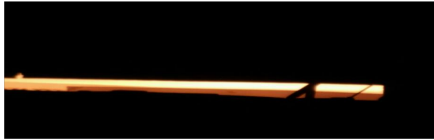
Gambar 3.2 Slab keluar dari Reheating Furnace
