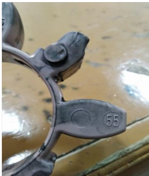
Gambar 31. Ukuran Karet Kopling yang digunakan (Sumber : Dokumentasi Pribadi)
