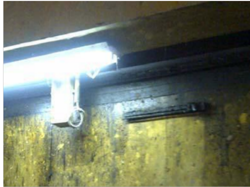
Gambar 25. Sensor Proximity pada Parraw (Sumber : Dokumentasi Pribadi)
