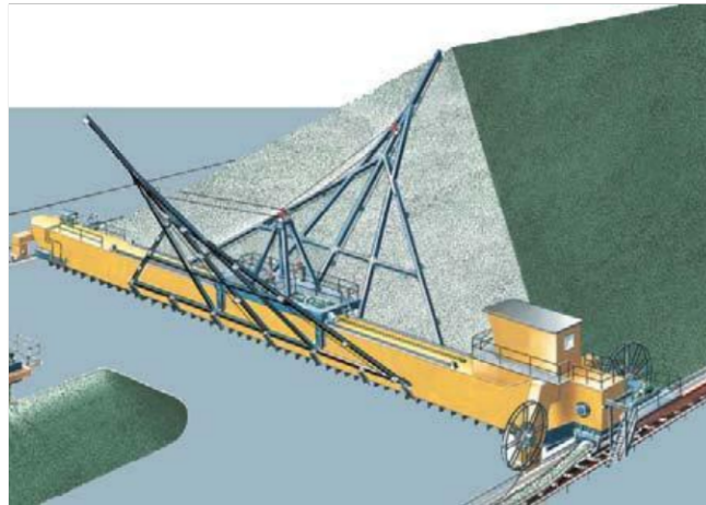
Gambar 7. Prinsip Kerja Bridge Scraper (Sumber : Data Perusahaan)
