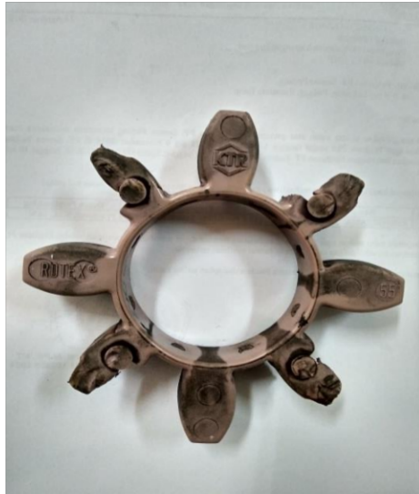
Gambar 34. Kegagalan Pada Karet Kopling (Sumber : Dokumentasi Pribadi)
