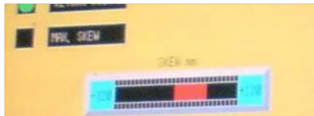
Gambar 21. Indikator Kemiringan Skew di Panel Kendali (Sumber : Dokumentasi Pribadi)
