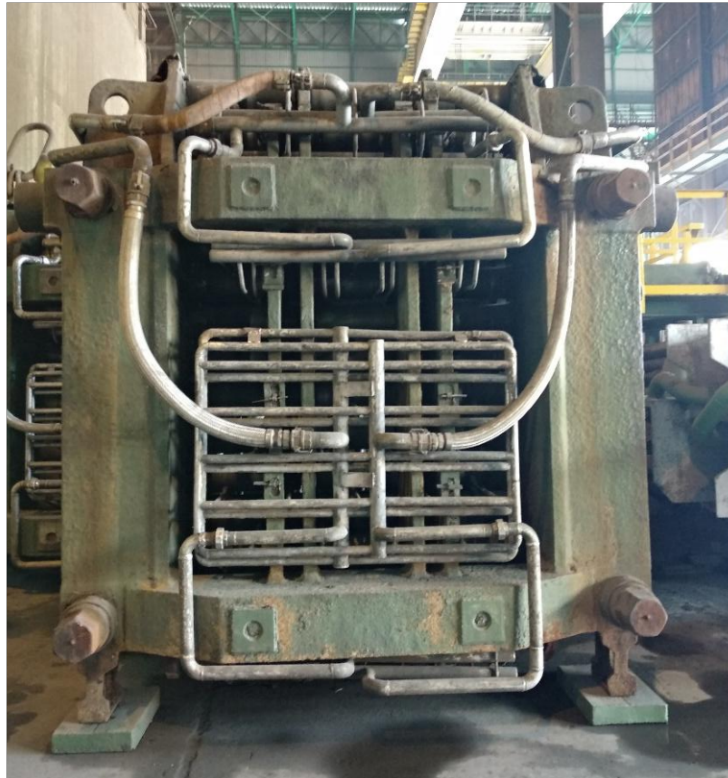
Gambar 41. Saluran udara dan air
