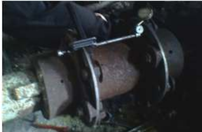
Gambar 2.10 Alignment pada Centrifugal Pump
