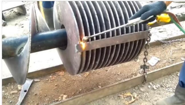
Gambar 4.8 pemotongan besi penggabung daun screw conveyer
