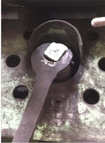
Gambar 3.8 Tension Bolt yang akan dilonggarkan
