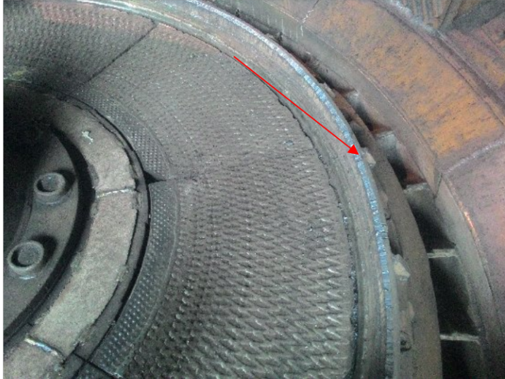
Gambar 3.3 Dam Ring dibuatkan tirus
