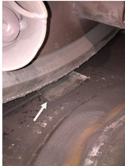
Gambar 3.7 Contoh Plat Zero diantara Tyre dan Table
