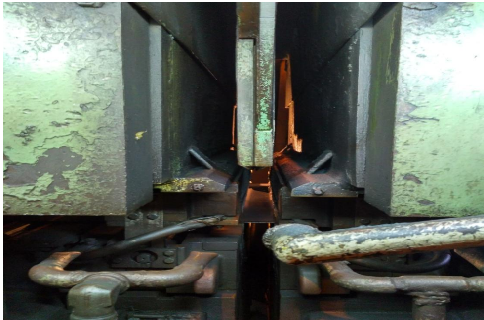
Gambar 4.30 Gauge Bar Dan Clamping D Set Komponen Mesin Flast Butt Welder
