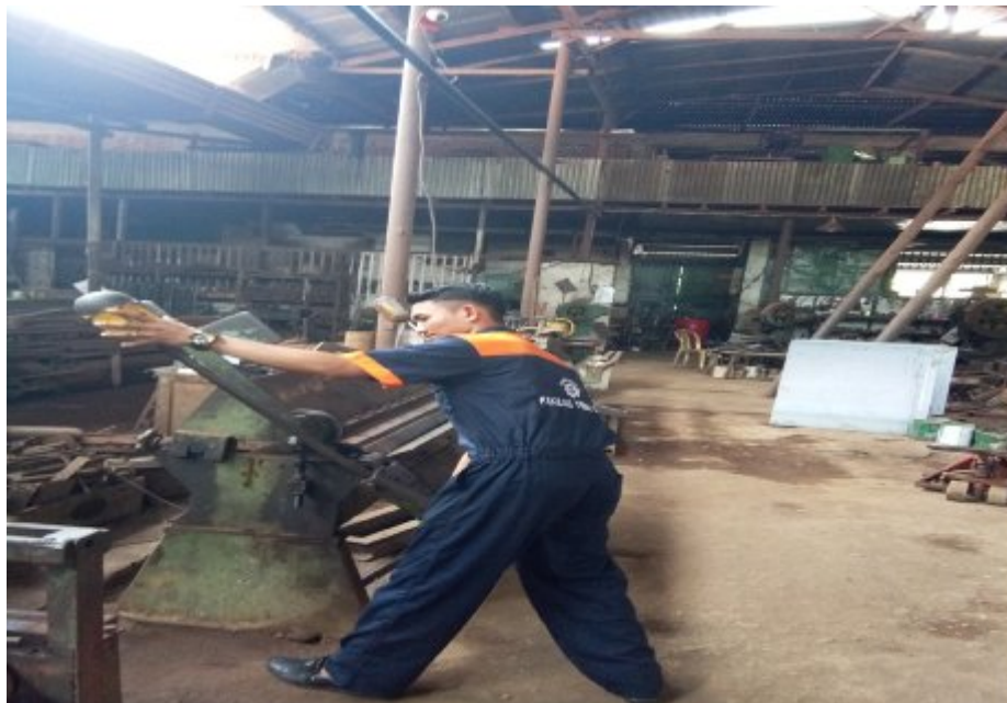
Lampiran 2. Proses pelekukan plat
