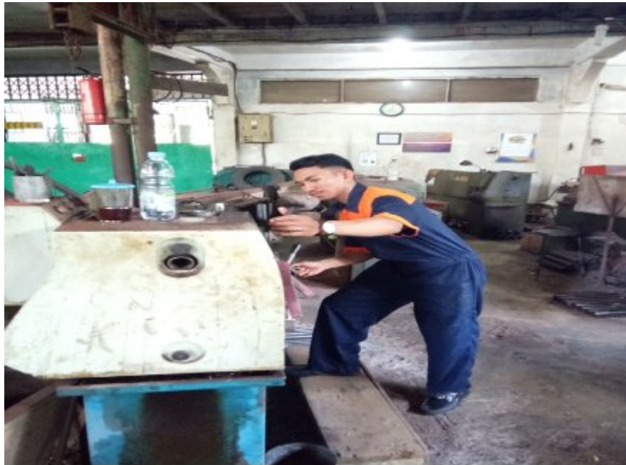
Lampiran 1. proses pembubutan poros
