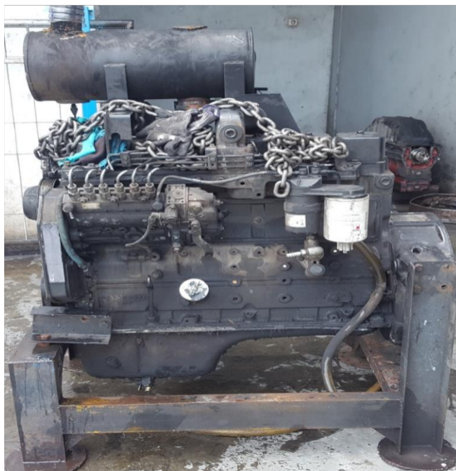
Gambar 7. Engine Cummins 6BTA5.9 yang terinstalasi pada unit Kawasaki Wheel Louder 60Z IV-2 . (Sumber : Dokumentasi Perusahaan)
