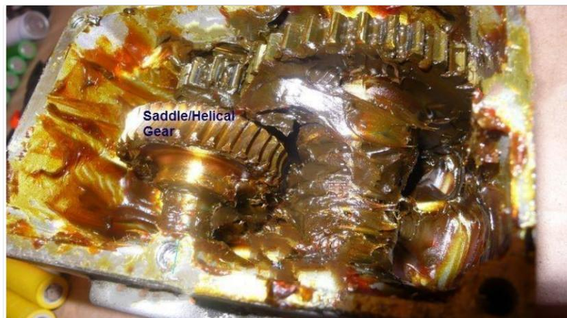
Gambar 2.4 Penambahan gemuk pada poros gear box dinamo utama mesin crusher
