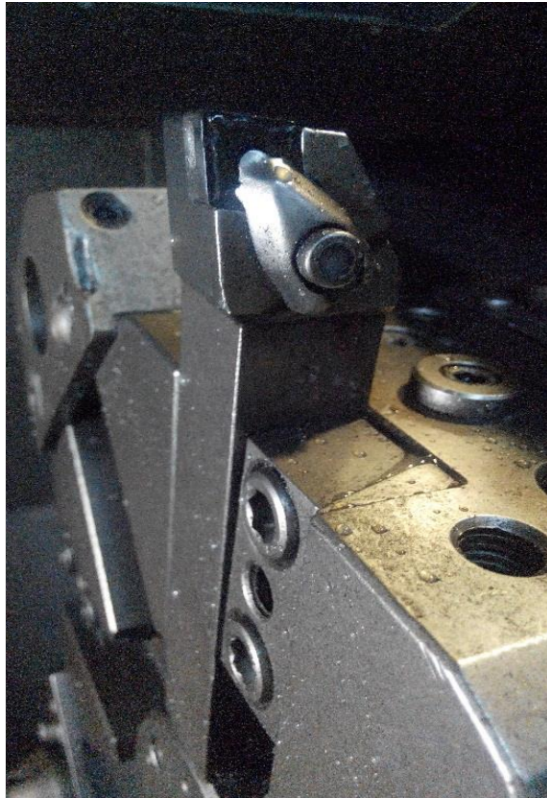
Gambar 27. Tool awal permukaan atas dan proses akhir permukaan luar
