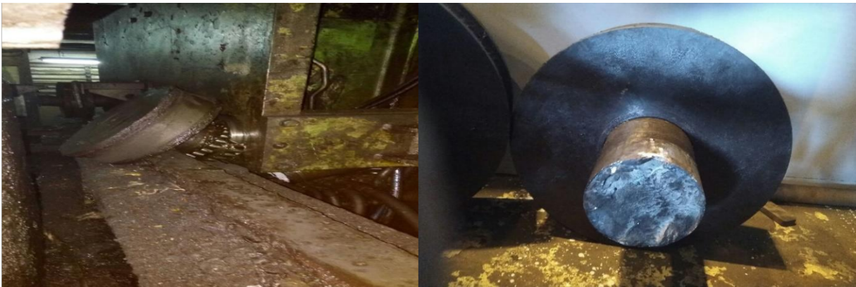
2.16 Bentuk patah shaft roda
