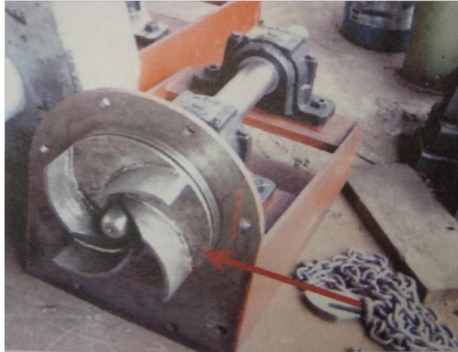
Gambar 26. *Impeller Vortex Pump*
