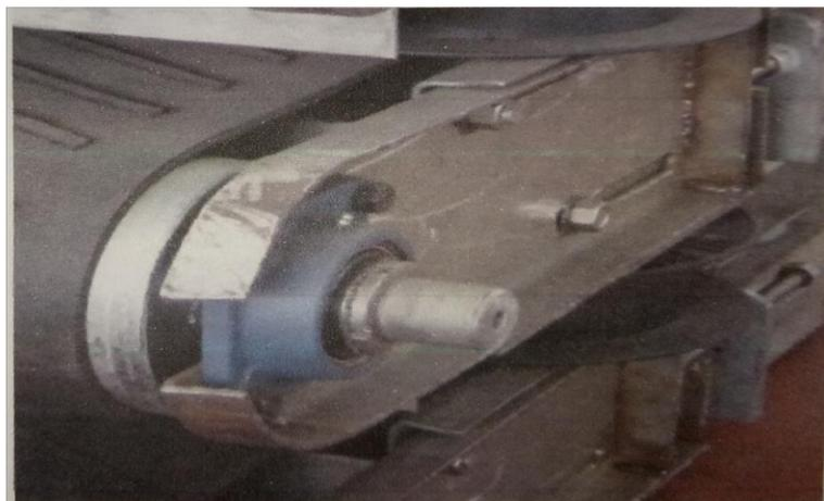
Gambar 14. *Penyetel Roll (Tensioner)*
