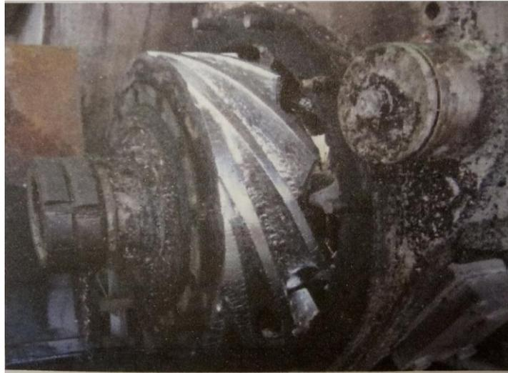
Gambar 27. Rotor *Blend Cutter*
