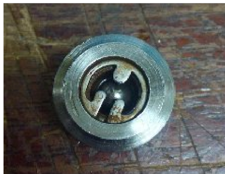
Gambar 4.6 Checkball sering mengalami kebocoran
