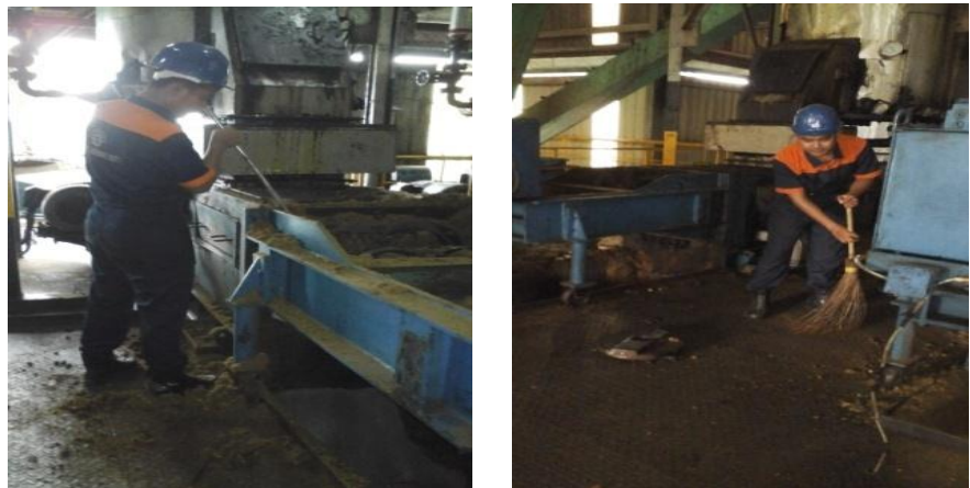
Gambar 2.17. Pembersihan Mesin Screw Press dari fiber dan nut
